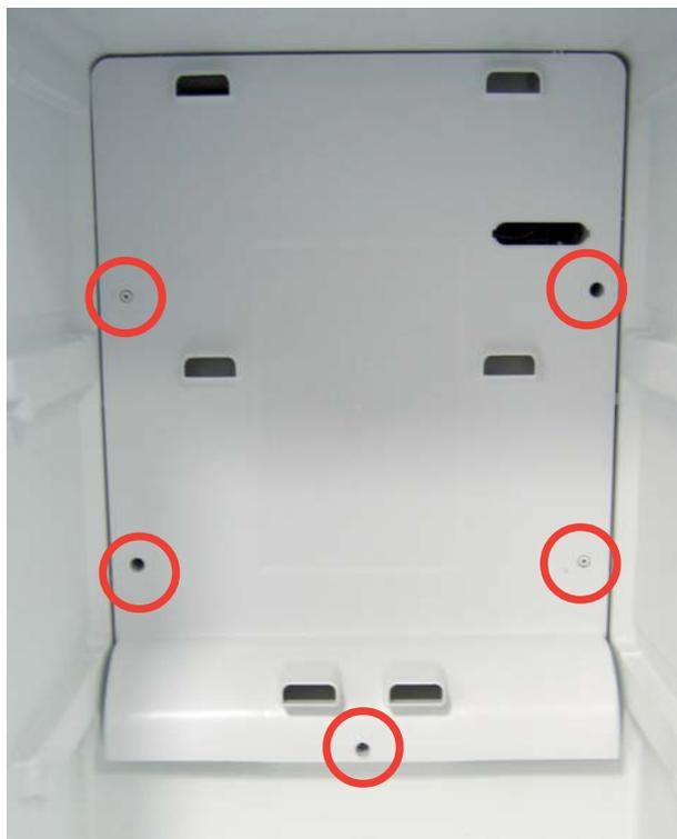
3 Introduire un tournevis plat dans les trous de la protection pour la décrocher.
