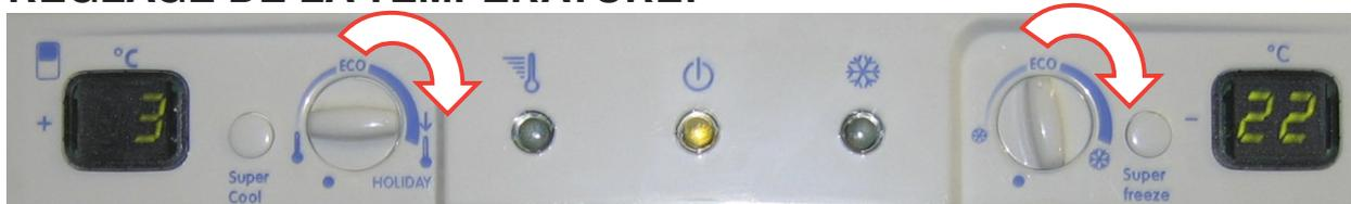
Pour diminuer la température, tourner le bouton du réfrigérateur (2) ou du congélateur (6) dans le sens des aiguilles d'une montre. Le tourner dans le sens inverse des aiguilles d'une montre pour augmenter la tempé-
