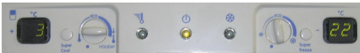
Ils affichent la température programmée par l'utilisateur dans le réfrigérateur et dans le congélateur en fonction de la position du bouton. La température du congélateur est comprise entre -18°C et
