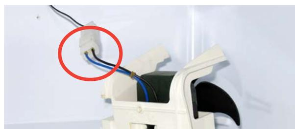
**Démontage du porte-ampoule:**
