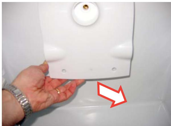
4 Dévisser les vis de la partie inférieure du multiflow et celle qui se trouve à l'intérieur du porte-ampoule.
