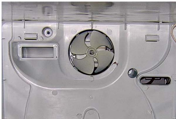
vrage est terminé, le ventilateur commence à fonctionner après l'écoulement d'un laps de temps prédéfini et stocké en MÉMOIRE à partir de la mise en marche du compresseur. Ce temps n'est pas le même qu'en fonctionnement normal.
